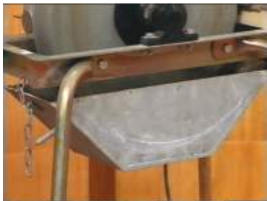
Fig. 12: Depósito de refrigeração
