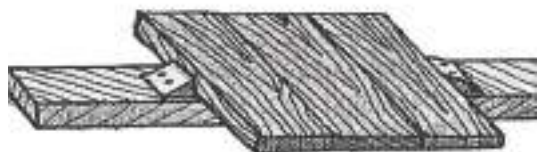
Colagem com a ajuda de tacos de madeira pregados
