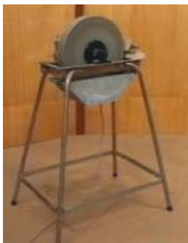
A retificação do chanfro é feita no rebolo (fig. 11).
